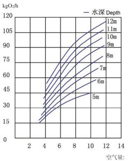
空气量: m³/min Volume of air: m³/min
